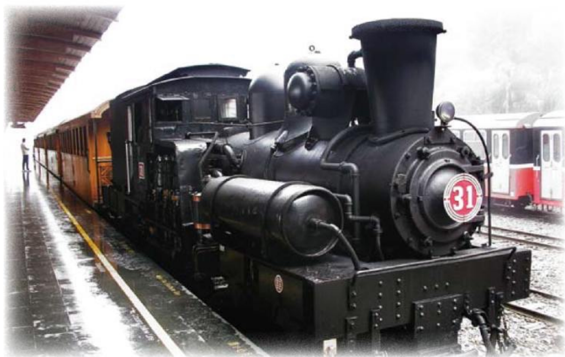
▲ 製造於1915年的阿里山SL-31號蒸氣小火車，是臺灣首部以燃燒柴油為動力的蒸汽機車。
