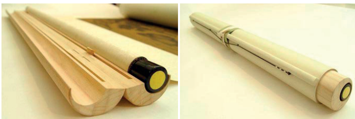
以外加式太捲增加軸徑，可緩解畫軸承受的捲收壓力。
