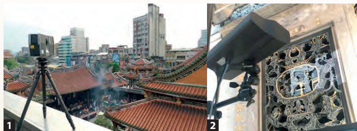
1. 3D 掃描作業（基站式掃描器）（陳姿妙提供）。 2. 建築雕飾的 3D 掃描作業（光柵式掃描器）。 * 本文之照片如未特別註明者皆為本寺提供。
