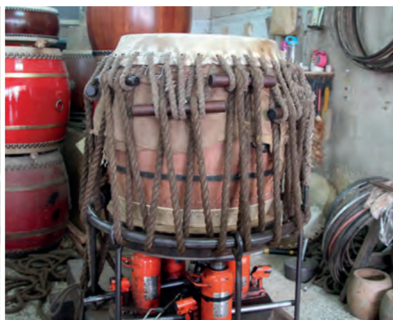
千斤頂用來調整鼓皮的鬆緊度。
